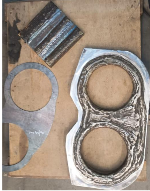
Şekil 1. Sert Dolgu kaynağı yapılmış aşınma plakası ve test numunesi.
